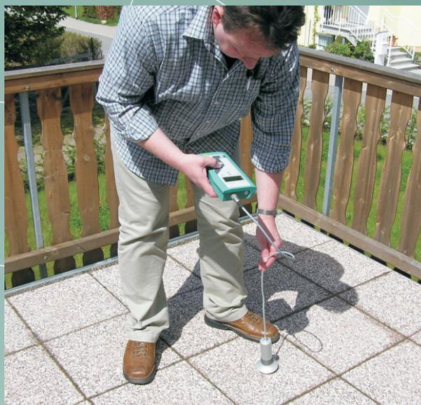
Das Beispiel zeigt eine Rasterfeuchtemessung an einem Flachdach über der Garage eines Einfamilienhauses. An den Wänden hervorgetretene Feuchteschäden führten zu dem Schluss, dass das Dach selbst feucht sein muss. Diese Vermutung wurde durch die Messungen bestätigt.
