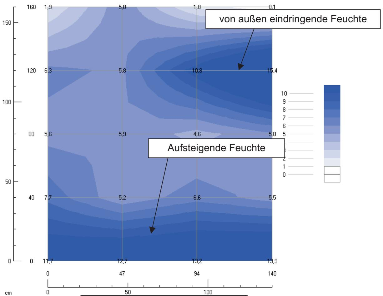
Messfeld 2 (Messung mit Tiefenmesskopf MOIST P)
