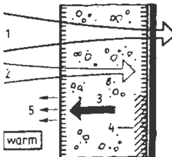
**Bild 5** Außenwandbereich- Kellermauerwerk, Feuchteverteilung mit und ohne Vertikaldichtung
